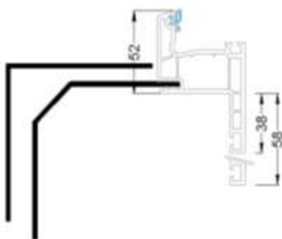
Pour une pose en Rénovation, un appui neuf est également disponible : il est **possible de combiner des montants DR38 avec un dormant D6 + Bavette de 62** en pièce d'appui
