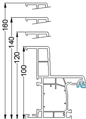
**Dormant Monobloc ou dormant Large (DL) :** dormant standard pour pose en neuf, avec tapées d'isolation incorporées. Disponible en :
