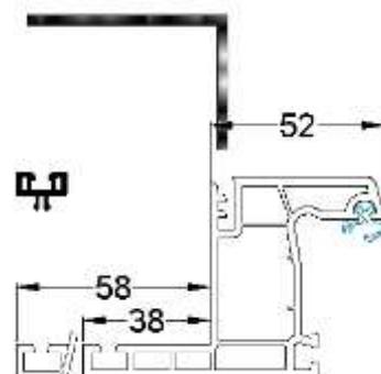
Avec aile de recouvrement intérieure de 38mm (DR38) ou de 58mm (DR58). Pose des dormants rénovation PVC à l'aide de vis SFS fournies.
